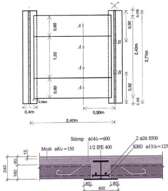
Fig. 2 – Tested slab (PROFILARBED, 1995).
