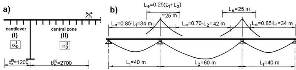
Fig. 6 – a) Parameter  $\alpha_0$ ; b) Effective length  $L_e$ .
