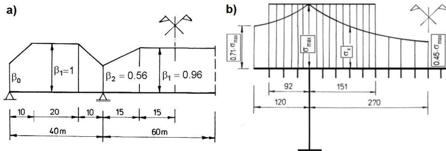
Fig. 7 – a) Diagram of parameter  $\beta$ ; b) Transverse tension stresses distribution.
